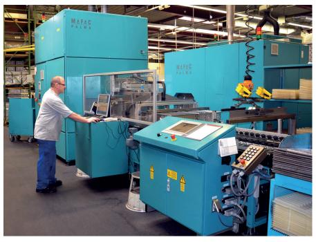
Bild 3: Für die hohen Durchsatzzahlen bei Grieshaber wurden zwei Dreitankanlagen mit Spritz-Flutverfahren angeschafft. Diese reinigen und trocknen täglich im Zweischichtbetrieb bis zu 250.000 Drehteile
