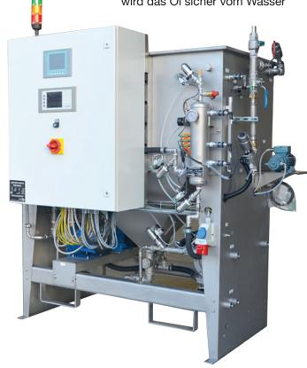
Bild 5 und 6: Das RTG Badpflegesystem sorgt für ein stabiles Reinigungsbad und bis zu 75 % Prozent weniger Partikel. Je nach Maschinenumgebung ist es als Einbau- oder Beistellmodul erhältlich. Es verfügt über einen Koaleszenz-Ölabscheider und bis zu drei automatische Dosiereinheiten für den optimalen Gehalt an Reiniger, Tensid oder Demulgator im Bad
